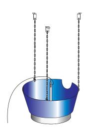
Grafik Filtergehäuse mit Filtereinsatz und Einhängeketten
