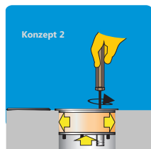
einfachster und absolut dichter Einbau durch patentierte Klemmdichtung
