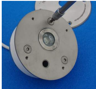
Tragplatte für Schwerlast, aus Vollmaterial gefräst, mit Klemmschrauben, durch Drehen nach rechts wird das System sicher fixiert und abgedichtet, durch Drehen nach links in Sekunden schnelle wieder auszubauen
