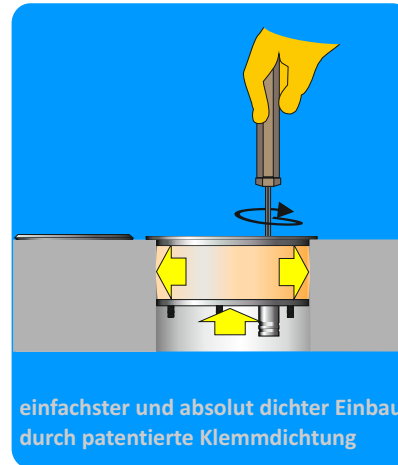
Tragplatte für Schwerlast, aus Vollmaterial gefräst, mit Klemmschrauben, durch Drehen nach rechts wird das System sicher fixiert und abgedichtet, durch Drehen nach links in Sekunden schnelle wieder auszubauen
