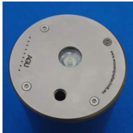
Deckplatte (Platte 1), Oberfläche gehärtet und mattiert durch Glaskugelstrahlung, mit Sicherheitsverschraubung
